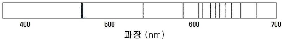
[그림 2] 네온 기체의 흡수 선 스펙트럼 ( $1\text{nm} = 1 \times 10^{-9}\text{m}$ )
