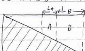
왼쪽 그림에서 쓰나미가 B부분을 이동할 때  $t$  시간 동안 이동한 거리가  $L_B$  라면 A부분은 같은 시간 동안 이동할 때는  $L_A$  정도의 거리만 이동할 수 있다. 따라서 바닷물의 부피를 고려했을 때, 쓰나미가 B에서 A로 진행하면 A부분의 파고가 더 높아야 한다. ( $H_A > H_B \Rightarrow V_A \neq V_B$ )
