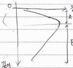
A 구간은 온도 증가에 따른 해수밀도 감소로 인하여, B 구간은 공기 증가에 따른 압력 증가가 주요 요인이다. 이는 [그림 6]의 값에 따른 온도 그래프와 반비례 관계이다.
