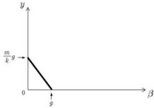
(2)  $\beta$ 의 크기가  $g$ 보다 커지면 물체 A가 상자의 윗면에 위치한 용수철을 압축하게 되므로  $m\beta = ky + mg$ 로부터  $y = \frac{m}{k}(\beta - g)$ 를 얻을 수 있다. 그런데,  $y$ 는  $l_0$ 보다 클 수 없으므로  $y = \frac{m}{k}(\beta - g) \leq l_0$  부등식으로부터  $\beta = \left(\frac{k}{m}l_0 + g\right)$ 가 될 때까지만 윗면에 있는 용수철을 부분적으로 압축하고,  $\left(\frac{k}{m}l_0 + g\right) \leq \beta \leq \frac{2k}{m}l_0$  구간에서는 용수철이 이미 완전히 압축된 상태이므로 윗면과 접촉하게 된다. 따라서 물체 A의 위치와 스프링의 상태를 그림으로 나타내면
